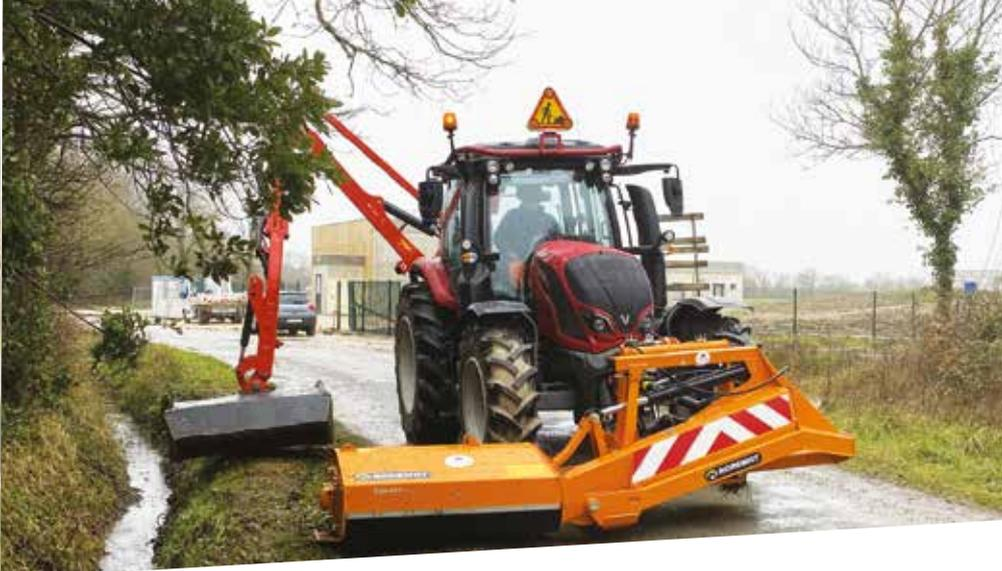
de route. Cette épareuse vient en remplacement de l'ancien tracteur. Ce nouvel équipement, va permettre aux agents un net gain de temps, d'efficacité et de précision. Equipé de deux broyeurs qui peuvent fonctionner simultanément, il peut ainsi effectuer deux largeurs de coupes en un seul passage.
