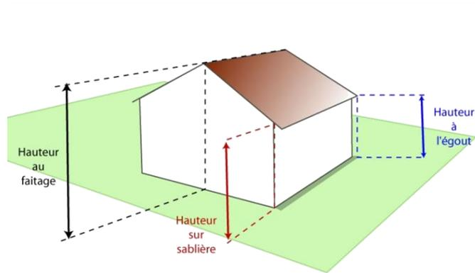
Exemple d'une adaptation à la pente, conditionnée par le respect des hauteurs maximales autorisées et définies en tout point du bâtiment
